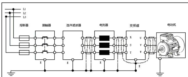
图 3-5: AC70 系列变频器系统接地
