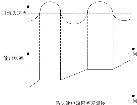
该参数基准值为变频器额定电流。使用该功能有可能会延长加速时间，变频器在启动过程中，如果频率不能按期望加速到给定频率，而停止在一个相对固定的频率段波动时，表明限流功能动作，这时请减轻负载或调整相关参数。
