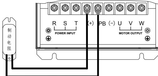
图 3-22: AC70 系列变频器 22KW (铁壳机)、30KW 机器制动电阻的连接图
