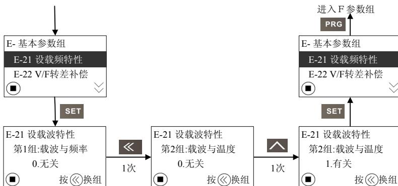
图 4-10：组操作界面流程
