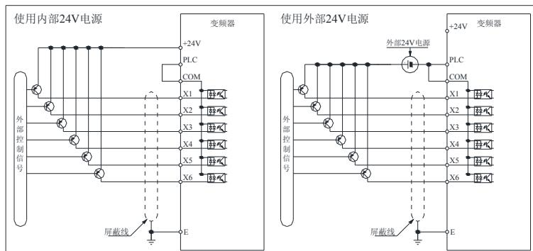
图 3-25: PNP 特性晶体管的数字输入信号连接方式
