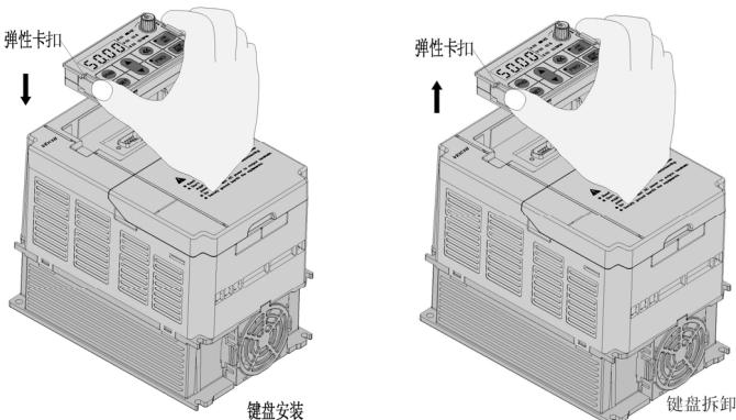
图 3-17：AC70 系列变频器键盘的拆除与安装
