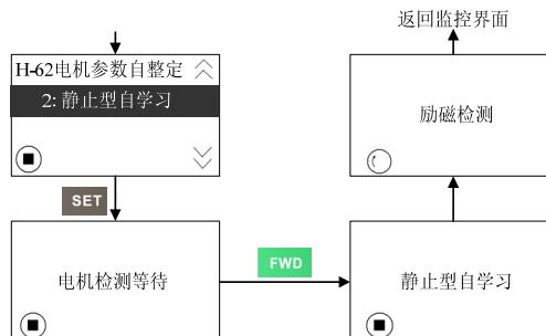
图 4-14：电机静止型自学习操作显示
