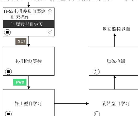
图 4-13：电机旋转型自学习操作显示
