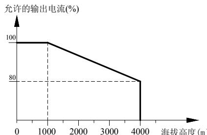
图 3-3: AC70 系列变频器超出允许的海拔高度后降额曲线图
