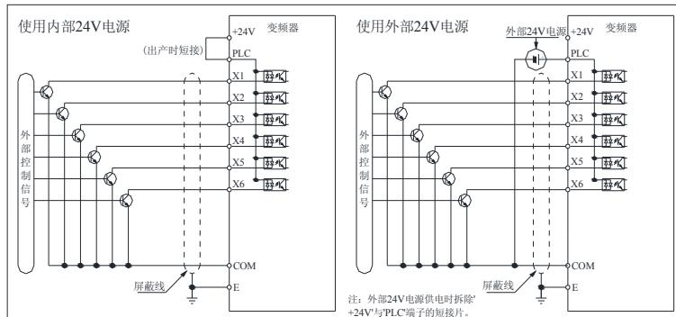
图 3-24: NPN 特性晶体管的数字输入信号连接方式
