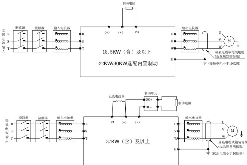
图 3-19: AC70 系列变频器主回路接线图
