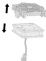
3、向外侧拨开风扇罩的卡扣，再稍用力分开冷却风扇和风扇罩。
