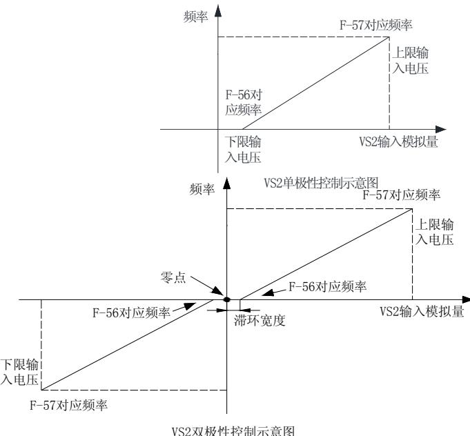
**提示：**当（VS2）用于PID给定或反馈通道时，双极性功能失效。此时（VS2）端子用法于（VS1）端子相同，即当（VS2）<0，变频器认为该端子输入为0。
