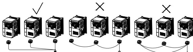
图 3-4: AC70 系列变频器多台联合接地
