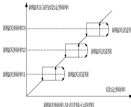
**提示：**1、在加减速过程中，变频器的输出频率仍会正常穿越跳跃频率区。不要将三个跳跃频率范围重叠或者嵌套设置。
