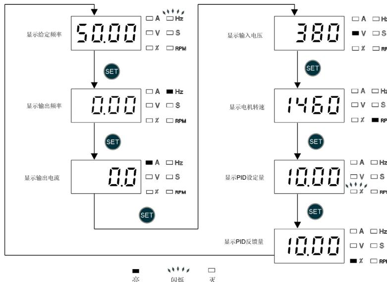
图 4-2：单行键盘循环切换显示示意图
