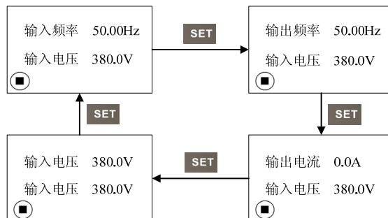
图 4-6：停机时上行监控参数显示更改
