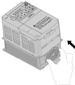
3、将风扇罩两弹性卡扣垂直插入变频器风扇安装卡槽中。
