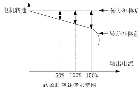
如果同自动转矩提升功能一起配合使用，可使变频器的低频力矩特性得到明显改善。转差频率补偿量的大小应根据电机额定转差来确定，不应将补偿值设定的过大。
