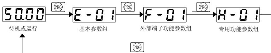
图 4-1：进退及三组菜单切换操作流程示意图
