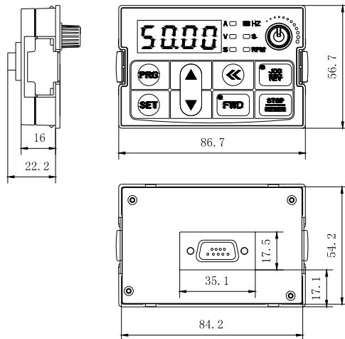
图 3-11: AC70 系列变频器单行键盘外形尺寸
