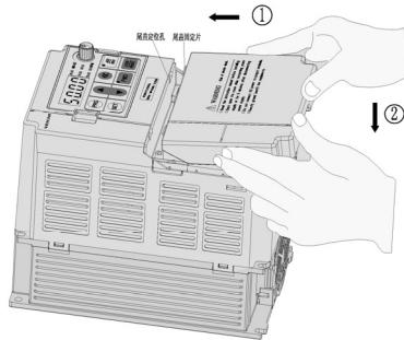
用手托住尾盖及变频器前盖的侧部,两大拇指放在提手孔位,稍用力向上顶起尾盖,直至尾盖底部两侧的卡扣都脱离卡槽位。然后再双手向后将固定片从固定孔中取出,尾盖拆卸完成。
