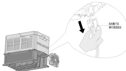
2、向内侧下压风扇引线端子弹性卡扣，同时稍用力垂直拉出风扇引线端子。
