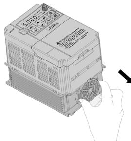
1、捏紧风扇的两边弹性卡扣，同时稍用力向外平行拉出，从变频器主体上拆下风扇罩。
