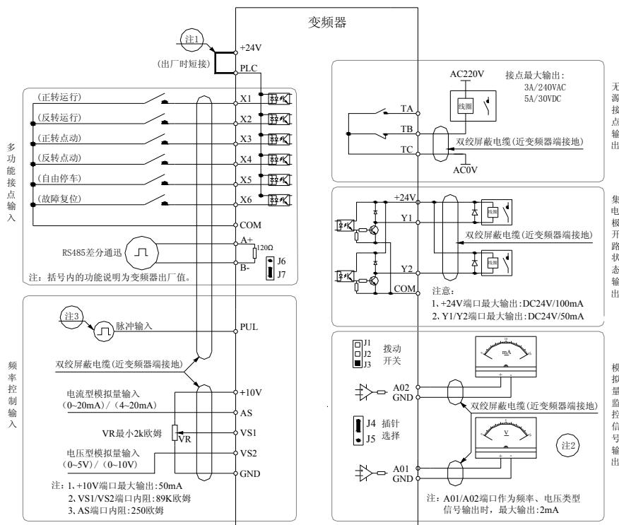
图 3-18: AC70 系列变频器控制回路接线图
