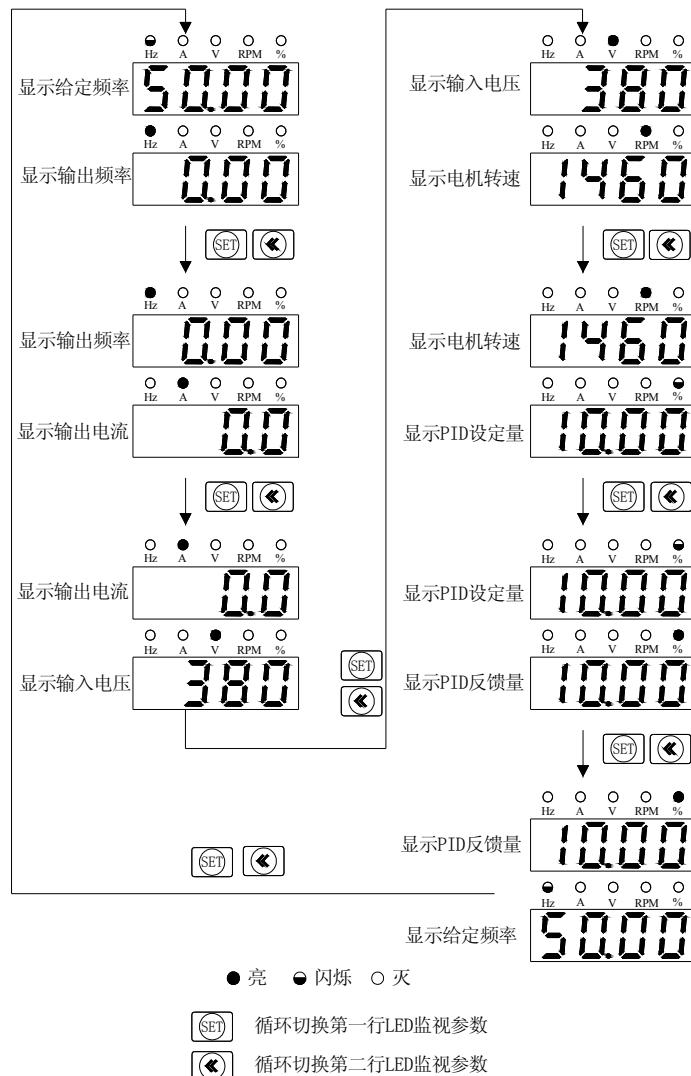
图 4-3: 双行键盘循环切换显示示意图
