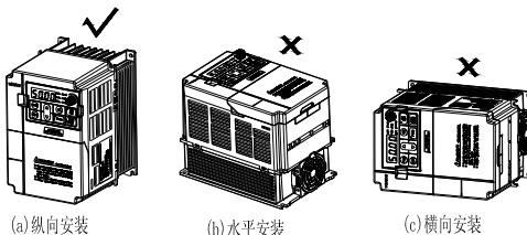
图 3-8: AC70 系列变频器安装方向
