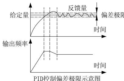
PID控制偏差极限示意图
