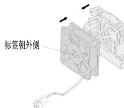
1、将冷却风扇如图所示（铭牌朝向外侧）垂直装入风扇罩内。
