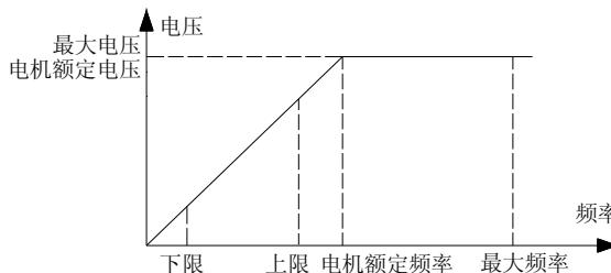
上、下限频率和最大频率关系示意图
