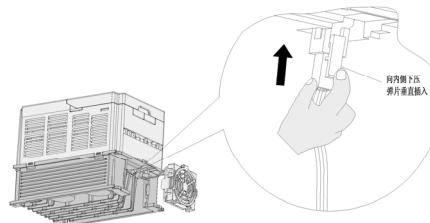
2、用手指向内侧下压风扇引线端子弹性卡扣，同时稍用力垂直插入风扇引线端子。
