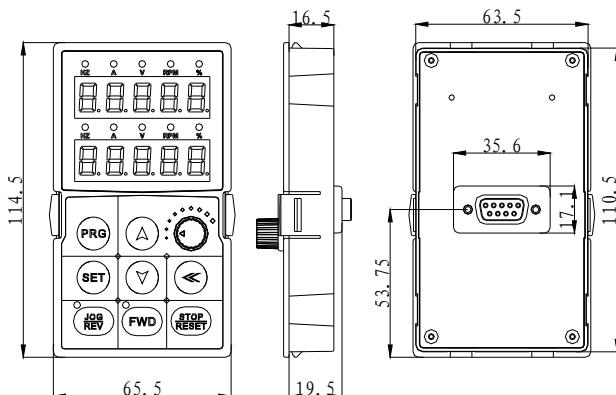
图 3-13: AC70 系列变频器双行键盘外形尺寸
